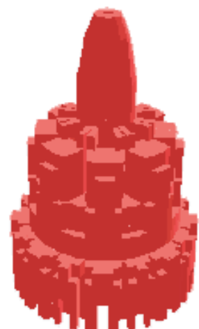
バイヨン主塔FEMモデル FEM model for the Bayon central tower.
